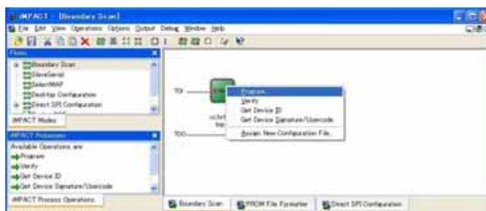
デバイスのアイコン上で右クリックをし、[Program...]をクリックしてください。FPGA へのコンフィギュレーションの際は、通常[Verify]のチェックを外してください。
