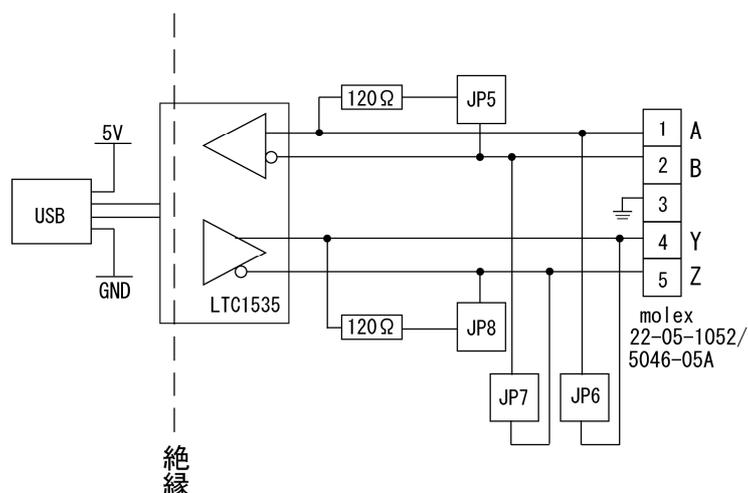
オンボード終端抵抗として 120Ω を搭載しております。ジャンパ (JP5, JP8) を切り替えることでご利用いただけます。
