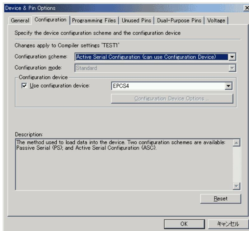
デバイスオプションで、Active Serial Configuration を選択し、Use configuration device として EPCS4 を設定してください。
