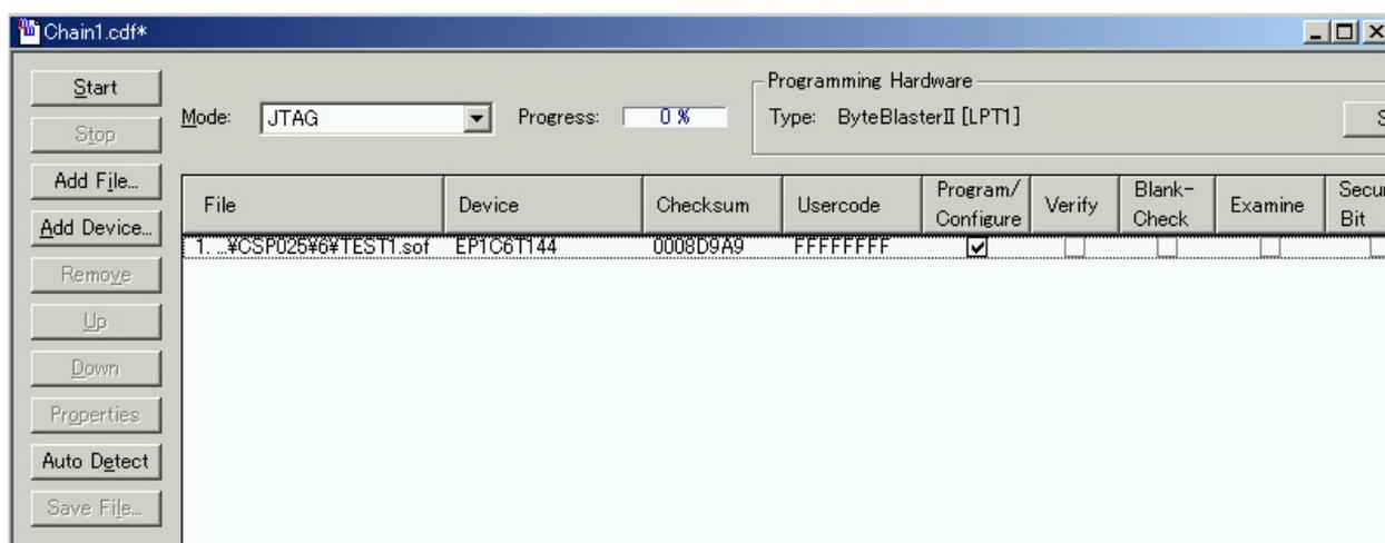
AutoDetect ボタンをクリックすると、実装されている FPGA が自動的に認識されます。コンパイルにより生成された SOF ファイルを設定し、コンフィグレーションを行います。
