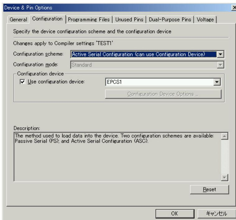
デバイスオプションで、Active Serial Configuration を選択し、Use configuration device として EPCS1 を設定してください（実装されている ROM タイプを選択）。
