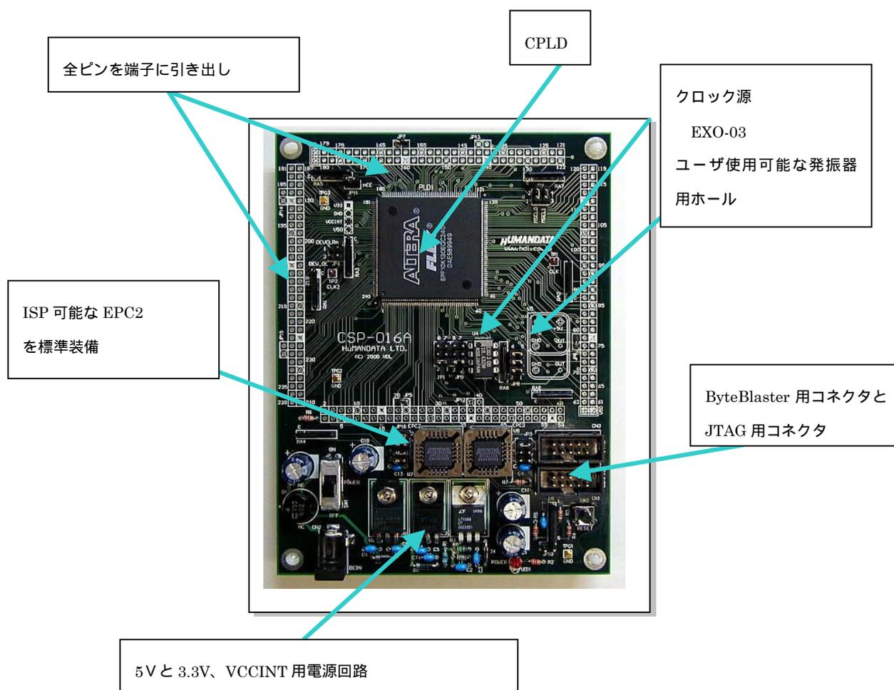
**注)** 写真は、CSP-016-130E です。モデルにより、EPC2 の個数、VCCINT 用電源の有無に差
