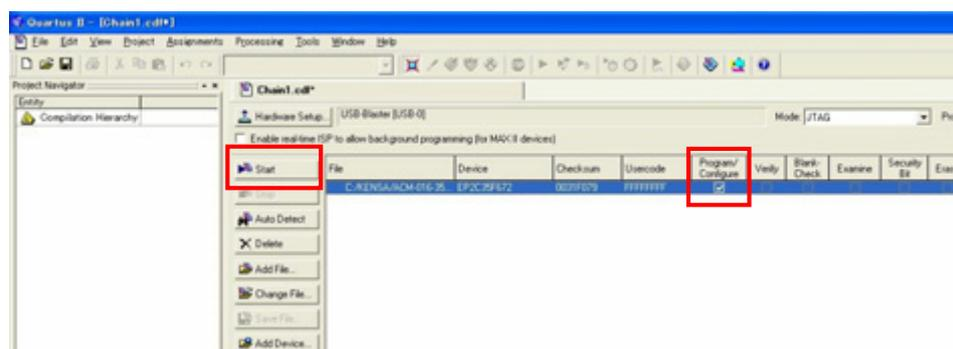
正常にコンフィギュレーションが出来れば ACM-018 のボード上の LED2 が点灯します。
