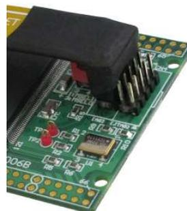
ダウンロードケーブル (USB Blaster 等) との接続には、付属のロングピンヘッダをご利用いただけます。
