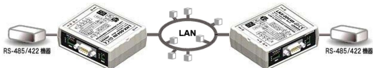
PCの介在なしに、LNX-004 同士が直接通信し、RS-485/422 回線同士を接続することができます
