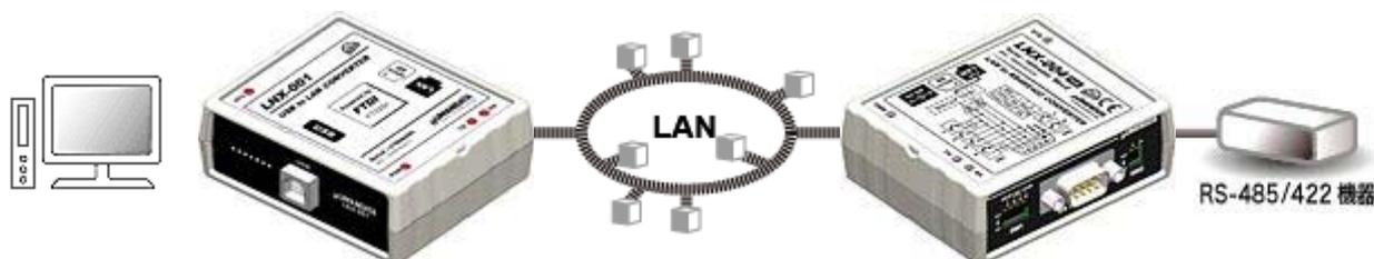
USB インタフェースから、PC の LAN を使用することなく離れた場所の RS-485/422 回線と通信ができます
