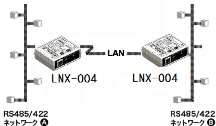
LNx-004 は、PoE 機能を標準搭載しているので、LAN ケーブルから電源を供給して動作することができます。(PoE 対応 HUB などが必要) 付属の AC アダプタによる動作も可能です。
