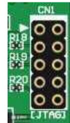
ダウンロードケーブルとの接続には、付属のロングピンヘッダをご利用いただけます。
