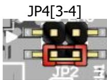
SHORT: FPGA ピンを FT2232H リセットに接続する
