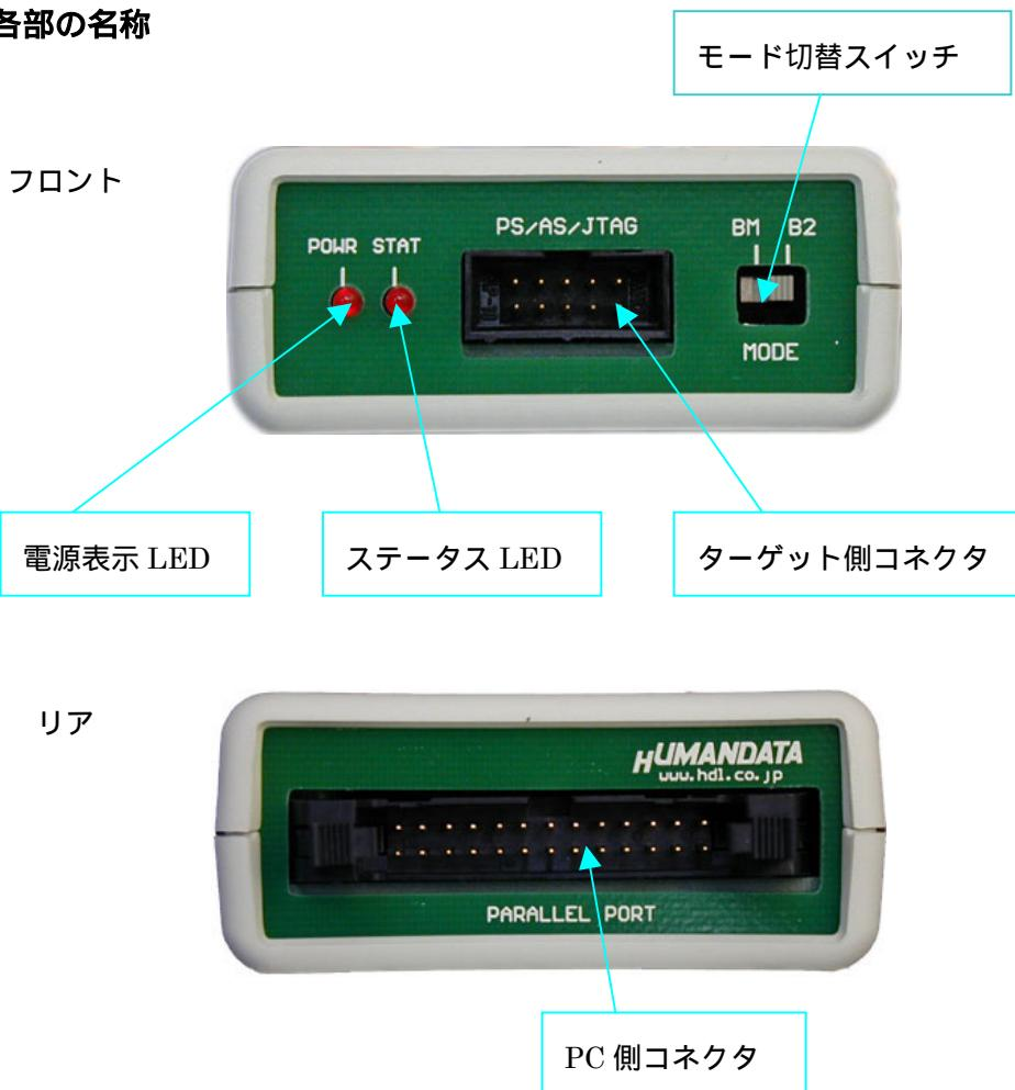
(電源表示 LED は、パソコン側からの漏れにより、ターゲットの電源が入っていない時でも薄く点灯することがあります。)
