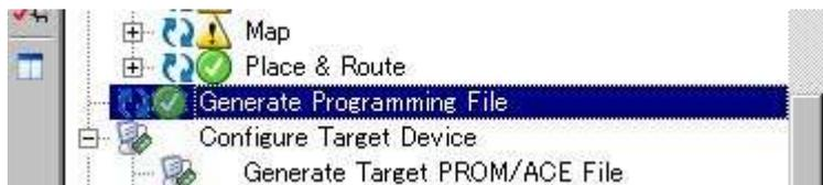
1. 【Generate Programming File】を右クリックして【Process Properties】を開きます
