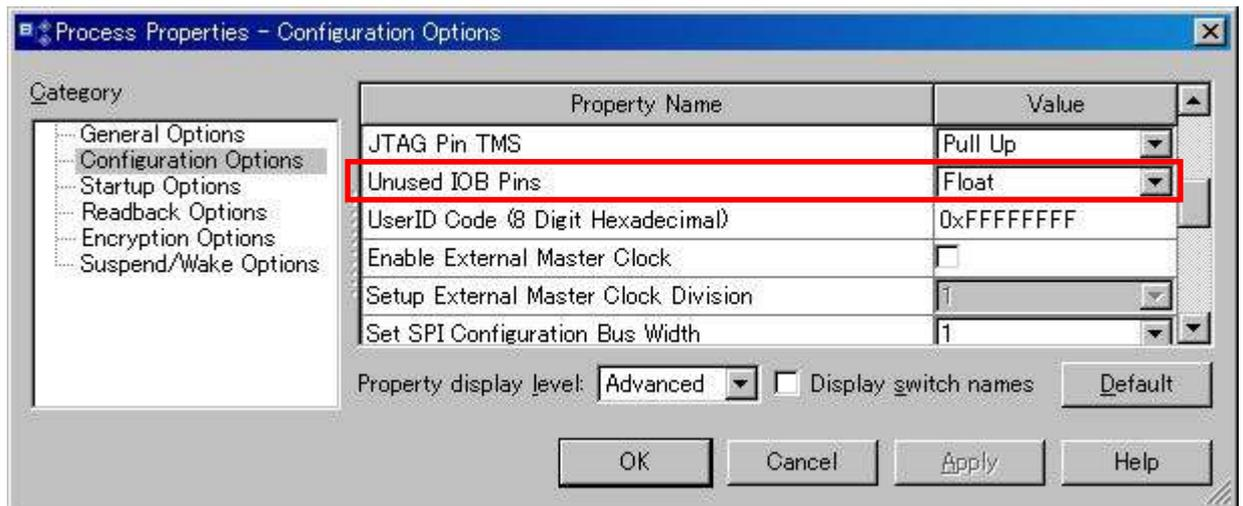
2.【Configuration Options】内の【Unused IOB Pins】を確認します
