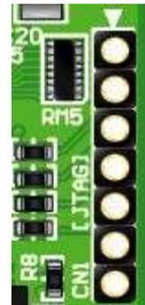
ダウンロードケーブルとの接続には、付属のロングピンヘッダをご利用いただけます。
