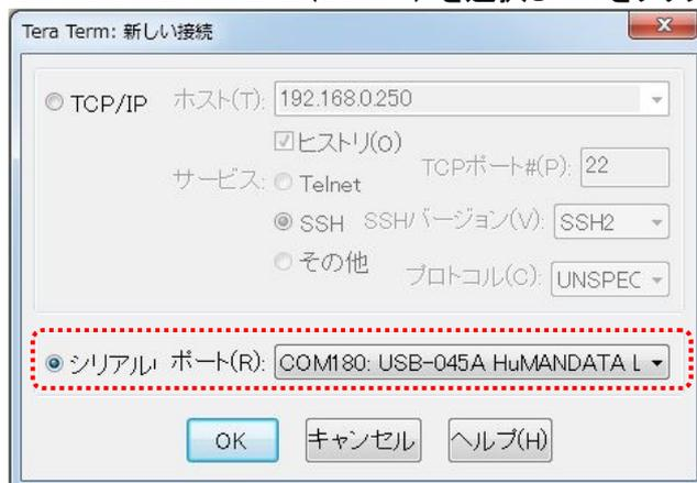
2. キー入力が表示されるようにするため、“端末の設定”でローカルエコー(L)にチェックを入れ、OK をクリックします。
