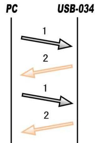
※K コマンド(電流出力中の断線検知機能)を有効にしている場合は PC からのコマンドがなくても断線を検知すると USB-034 から“ER001”が送信されます
