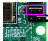
**注** : 本来はどのモードでも JTAG 経由のコンフィグレーションは可能ですが、ROM の内容が不定 (BLANK 含む) の時には、AS モードでのコンフィグレーションが動作中のため、PS モードにすることで安定したコンフィグレーションが可能です。
