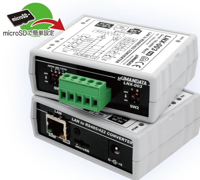
LNX-003は、イーサネット経由でRS-485/RS-422を使うことができるLANコンバータです。RS-485/RS-422側は絶縁されています。LNX-001と接続してトンネリングモードで接続が可能。LNX-003同士での接続もできます。
