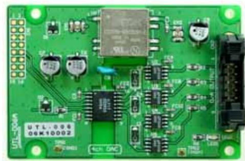
UTL-006 は、絶縁型の D/A 変換器を 4CH 実装したモジュール基板です。FPGA やマイコンに接続して使用することができます。D/A には LTC1655 を用いています。
