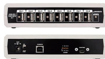
8つのUSBポートを切り換えることのできるUSBマルチプレクサもございます。PCからUSBポートを切り換えることにより、USB機器の自動検査時に1度のセッティングで8台の検査を実行することが可能になるなど、検査工程の省力化の推進が期待されます。
